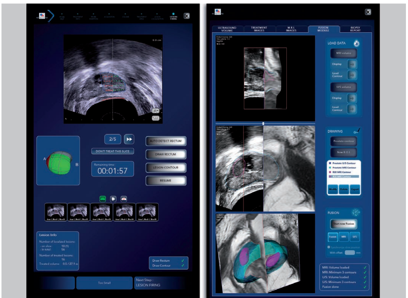
Abb. 4: Beispielhafte Darstellung des Gerätemonitors während einer Focal One®-Behandlung. Auf der linken Seite ist das aktuelle Behandlungsareal in Echtzeit dargestellt, auf der rechten Seite die der Behandlungsplanung zugrunde liegende Fusion von MRT- und Ultraschallbild.
